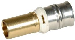
Press-Adapter aus entzinkungsbeständigem Messing zur Verbindung von alpex F50 PROFI Mehrschichtverbundrohren mit Kupfer-, C-Stahl oder Edelstahlpresssystemen mit V oder M Kontur in Trinkwasser- und Heizungssystemen. Mit weißem Fixierring mit integrierten Sichtfenstern, fixierter Edelstahlpresshülse und Leckagefunktion.
