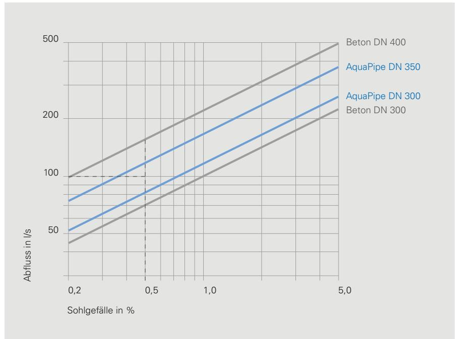
Beispiel: Für 100 l/s Abfluss bei 0,5 % Gefälle reicht AquaPipe DN 350. In Beton wäre DN 400 notwendig.
