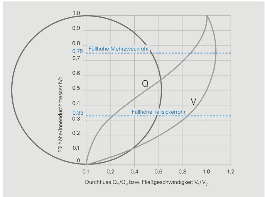
Zur Ermittlung von Abflussleistungen (Vollfüllung) kann mit dem Hydraulikdiagramm gerechnet werden.
