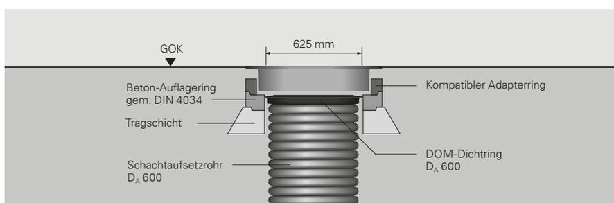
Abdeckung zum Einwalzen in bituminöse Fahrbahnbeläge
