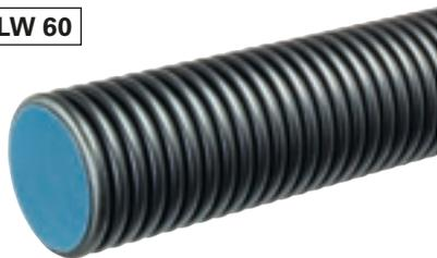
Transportrohr aus PE-HD in Verbundrohrbauweise (außen gewellt, innen glatt), einschließlich Dichtring und Muffe. Außen schwarz, innen blau. Extrem belastbar (SN 8 nach DIN EN ISO 9969). Entsprechend REwS (Richtlinien für die Entwässerung von Straßen) einsetzbar.
