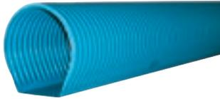
Teilsicker- und Mehrzweckrohre aus PVC-U nach DIN 4262-1 Typ C1 (vormals Form F), Wassereintrittsfläche  $\geq 50 \text{ cm}^2/\text{m}$ , Schlitzbreite  $1,2 \text{ mm} \pm 0,4 \text{ mm}$ . Entsprechend REwS (Richtlinien für die Entwässerung von Straßen) einsetzbar, SN 4 nach DIN EN ISO 9969.
