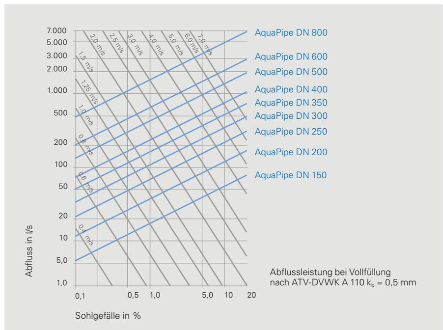
Der von Nennweite (DN) und Sohlgefälle (%) abhängige Abfluss (l/s) und die Strömungsgeschwindigkeit (m/s)
