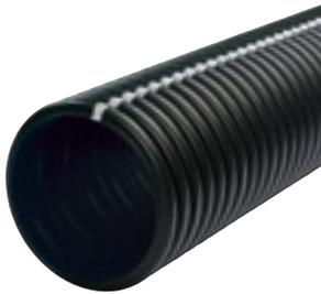
Teilsicker-, Vollsicker- und Mehrzweckrohre aus PE-HD nach DIN 4262-1, Typ R2, Wassereintrittsfläche  $\geq 50 \text{ cm}^2/\text{m}$  für LP, TP, MP, Schlitzbreite  $1,2 \text{ mm} \pm 0,4 \text{ mm}$ . Entsprechend REwS (Richtlinien für die Entwässerung von Straßen) einsetzbar; SN 4 nach DIN EN ISO 9969.
