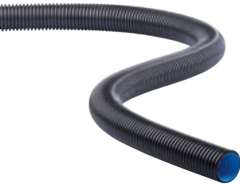
Flexibles Rohr aus PE in Verbundrohrbauweise (außen gewellt mit Innenrohr). Außen schwarz; innen blau. Extrem belastbar (SN 8 nach DIN EN ISO 9969); ohne Muffe. Durch seine Flexibilität kann auf Formteile wie Winkel und Bögen verzichtet werden.
