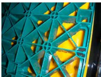
Gereinigte, rückstandsfreie Anlage, hier im Bereich Strömungstrenner
