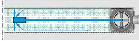
Spüldruck ca. 90 – 120 bar (analog der Reinigung von Kunststoffkanalrohren)
