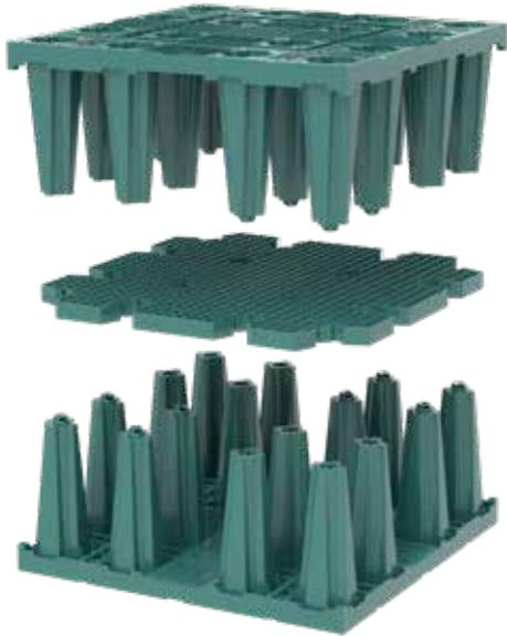
Das Zwischengitter wurde konzipiert, um die Anwendungsbereiche bei erhöhten Anforderungen zu erweitern wie z.B. bei gedichteten Anlagen im Falle von anstehendem Grund-, Stau- oder Schichtenwasser, oder mehrlagigen Rigolen mit hohen Einbautiefen (> 6m). Derartige Einbausituationen haben zur Folge, dass eine erhöhte horizontale Belastung (z.B. in Form von Wasserdruck) auf die Blockanlage wirkt und die Einbaugrenzen eingeschränkt werden.
