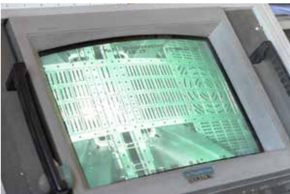
Im Kanalbau gehört es zum Standard und ist längst zur Selbstverständlichkeit geworden – die Bauabnahme der Haltungen durch Kamerabefahrung. Auch beim Rigolenbau ist die Abnahmebefahrung wichtig! Planer sollten diese unbedingt in den Ausschreibungstext mit aufnehmen.
