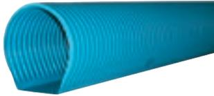
Teilsicker- und Mehrzweckrohre aus PVC-U nach DIN 4262-1 Typ C1 (vormals Form F), Wassereintrittsfläche  $\geq 50 \text{ cm}^2/\text{m}$ , Schlitzbreite  $1,2 \text{ mm} \pm 0,4 \text{ mm}$ . Entsprechend RAS-Ew (Richtlinien für die Anlage von Straßen, Teil: Entwässerung) einsetzbar, SN 4 nach DIN EN ISO 9969.
