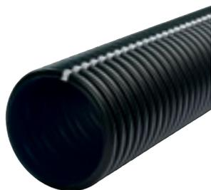
Teilsicker-, Vollsicker- und Mehrzweckrohre aus PE-HD nach DIN 4262-1, Typ R2, Wassereintrittsfläche  $\geq 50 \text{ cm}^2/\text{m}$  für LP, TP, MP, Schlitzbreite  $1,2 \text{ mm} \pm 0,4 \text{ mm}$ . Entsprechend RAS-Ew (Richtlinien für die Anlage von Straßen, Teil: Entwässerung) einsetzbar; SN 4 nach DIN EN ISO 9969.
