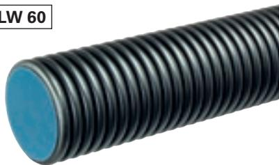
Transportrohr aus PE-HD in Verbundrohrbauweise (außen gewellt, innen glatt), einschließlich Dichtring und Muffe. Außen schwarz, innen blau. Extrem belastbar (SN 8 nach DIN EN ISO 9969). Entsprechend RAS-Ew (Richtlinien für die Anlage von Straßen, Teil: Entwässerung) einsetzbar.
