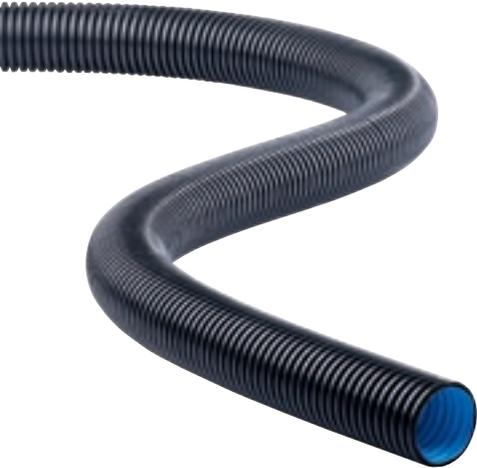
Flexibles Rohr aus PE in Verbundrohrbauweise (außen gewellt mit Innenrohr). Außen schwarz; innen blau. Extrem belastbar (SN 8 nach DIN EN ISO 9969); ohne Muffe. Durch seine Flexibilität kann auf Formteile wie Winkel und Bögen verzichtet werden.
