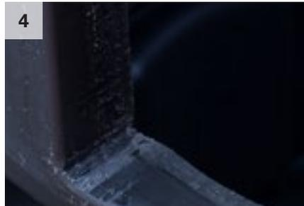
Die entstandenen Grate und Unebenheiten der Trennfläche sind mit Schaber, Feile oder sonstigem geeignetem Werkzeug zu entfernen.
