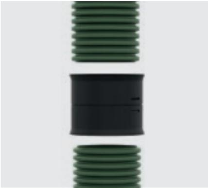
Nach der Herstellung der Vliesumhüllung und seitlichen Verfüllung (siehe nachfolgende Kapitel) sind die Schachtaufsetzrohre zu montieren. Die Doppelsteckmuffe ist auf den RigoControl Schacht aufzustecken. Danach ist das Schachtaufsetzrohr in die Muffe zu stecken. Es ist darauf zu achten, dass die Schächte und Schachtaufsetzrohre senkrecht eingebaut und beim Verdichten nicht verschoben werden.
