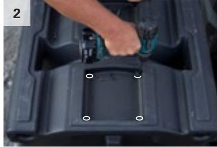
In den Ecken der zurückgesetzten Fläche jeweils ein Loch bohren,  $\varnothing$  min. 12 mm (Bohrdurchmesser muss größer sein als das zu verwendende Sägeblatt).
