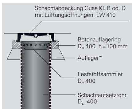
Schachtabdeckung auf Schacht (z. B. Kontrollschacht)
