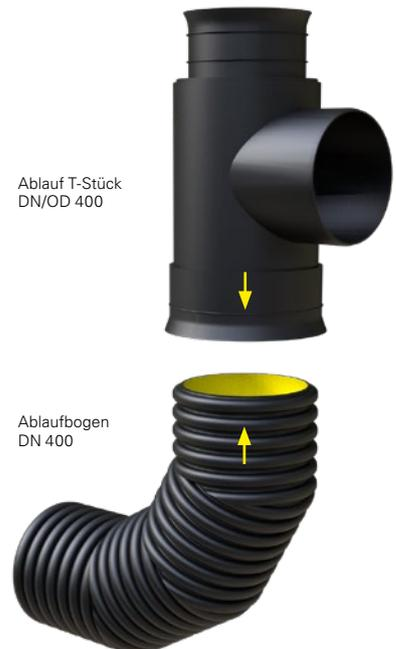
Noch außerhalb der Baugrube ist der Profildichtring DN 400 im zweiten Wellental des Ablaufbogens aufzuziehen. Rohr, Profildichtring und Muffe sind sauber zu halten. Anschließend sind Profildichtring und Muffe ausreichend mit Gleitmittel einzustreichen. Es ist darauf zu achten, dass keine Verschmutzungen im Dichtbereich anhaften. Anschließend ist der Ablaufbogen wie dargestellt mit dem Zielsegment zu verbinden.
